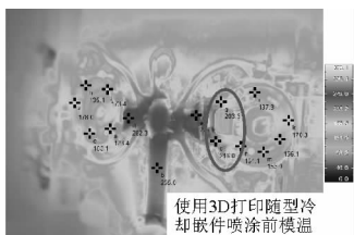
图 6 使用 3D 打印随型冷却嵌件喷涂前模温
