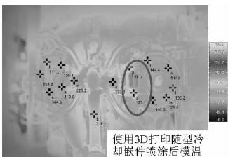
图 8 使用 3D 打印随型冷却嵌件喷涂后模温
